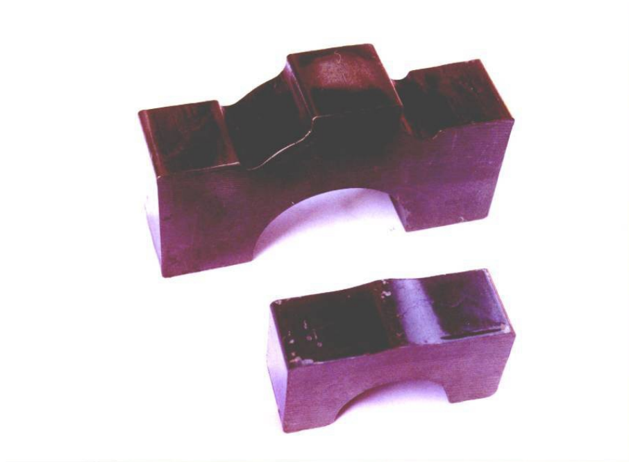
figura 7 - Capas de mancal em ferros fundidos cinzento e nodular, obtidas por fundição contínua.
