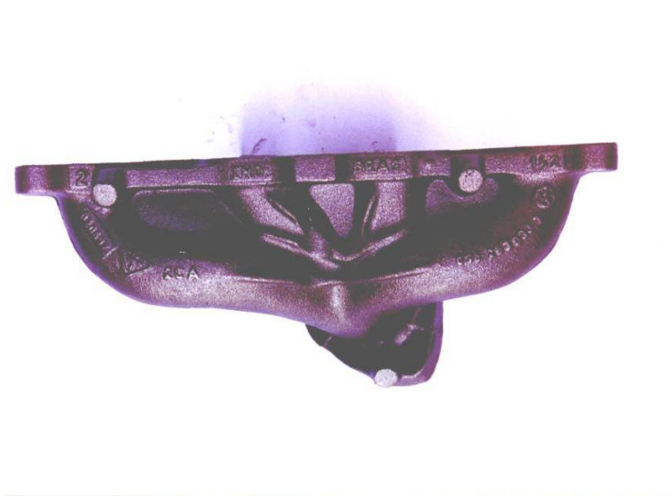
figura 3 – Coletor de escapamento produzido em ferro fundido vermicular SiMo.
