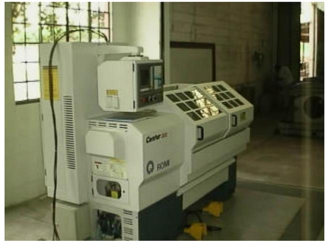
Figura 2. Torno CNC ROMI, modelo Centur 30D.
